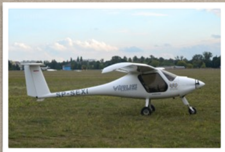
Samoloty ultralekkie do zdjęć z większej wysokości (ortofotomapy ) i monitoringu długich odcinków autostrad.
