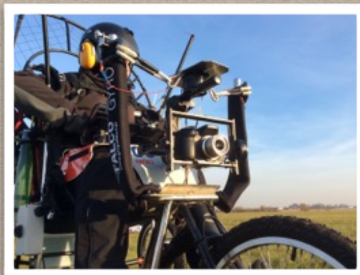
Motoparalotnie jedno i dwuosobowe ze stabilizacją żyroskopową do zdjęć z niskiego pułapu.
